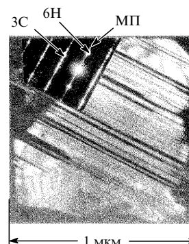
Рис. 1. Строение гетерофазного (6H + 3C + МП) кристалла SiC.
